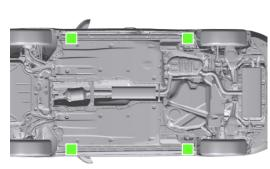
Pontos de levantamento adequados
